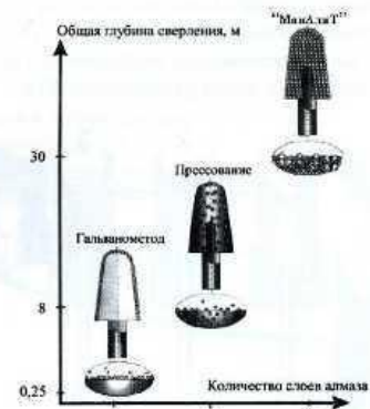
Рис. 6. Ресурс алмазных кольцевых сверл Ø6 мм, изготовленных с примесью различных типов связок
