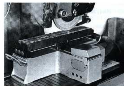
Рис. 8. Установка для исправления угла среза монокристаллов
