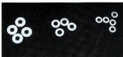
Рис. 9. Чувствительные элементы для датчиков расстояния и вибрации из лангата
